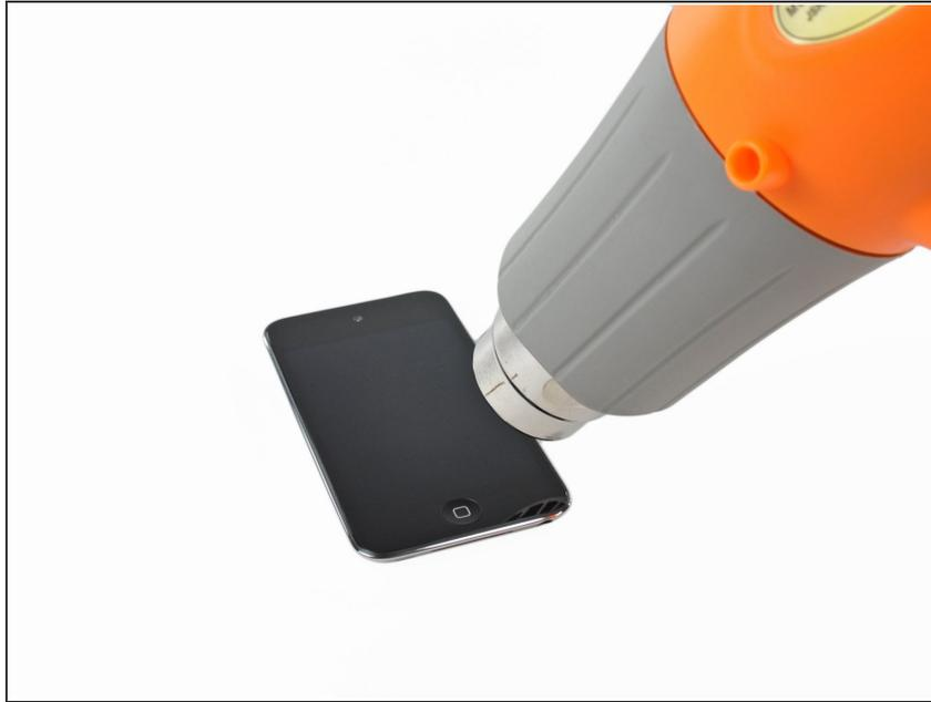
**i** El panel frontal del iPod Touch de cuarta generación está unido a la caja trasera mediante adhesivo. El uso de una pistola de calor para suavizar el adhesivo es muy recomendable.
