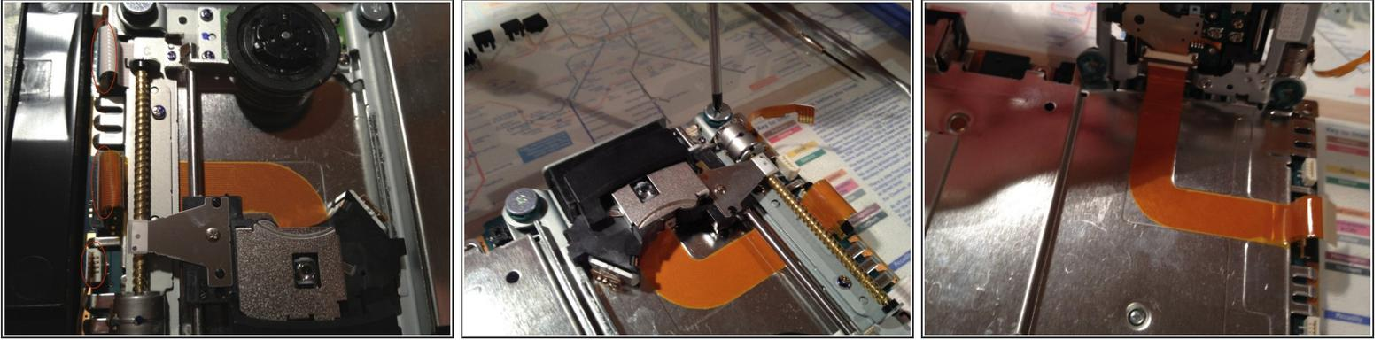
**i** Hay tres cables que conectan la unidad óptica a la placa base.
