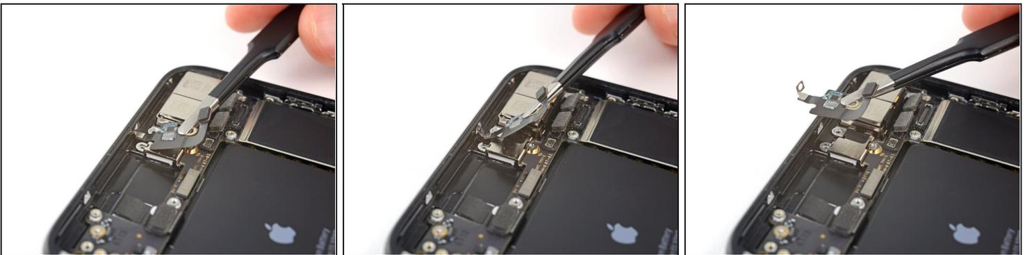
ⓘ El tornillo en la parte superior del cable flexible de la antena está metido en un pequeño rebaje en el borde superior del iPhone.
