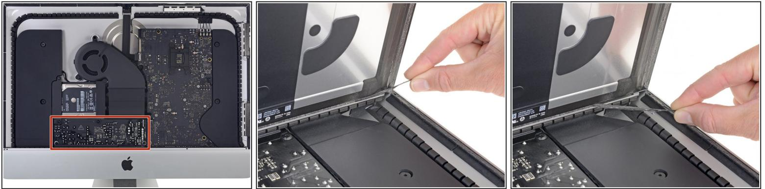
**⚠** Tenga cuidado y no toque ningún capacitor o alguna soldadura expuesta en la parte trasera de la fuente de energía (caja roja)
