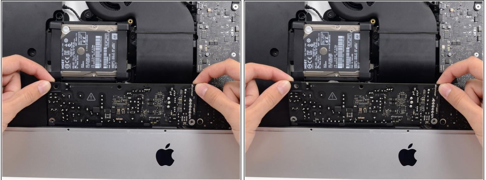
⚠ Cuando trabajes en la fuente de energía, **ten mucho cuidado** de no tocar los pines del capacitor o cualquier soldadura expuesta en la parte trasera de la fuente de energía. Sólo maneja la placa por los bordes.
