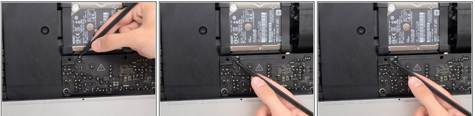
**⚠** Los siguientes pasos llevan tus manos cerca de la cara expuesta de la fuente de energía. **No** toques la cara de la fuente de energía o alguna de las soldaduras expuestas. Tocarlas supone el riesgo de recibir una descarga de alto voltaje de alguno de los capacitores de gran tamaño soldados a la placa.
