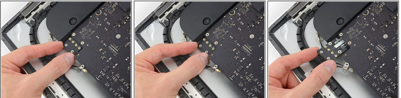
**⚠ No apartes la tarjeta de la placa lógica más de 1-2 mm. Hacerlo puede causar daños severos.**
