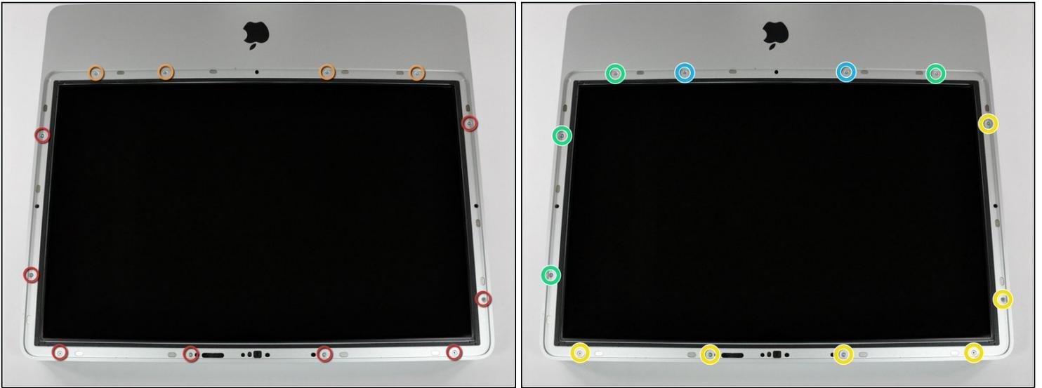
● Retira los siguientes 12 tornillos que sujetan el bisel frontal a la carcasa trasera:
