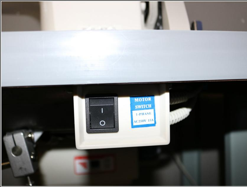
**⚠ Asegúrate de apagar la máquina antes de reemplazar el prensatelas.**
