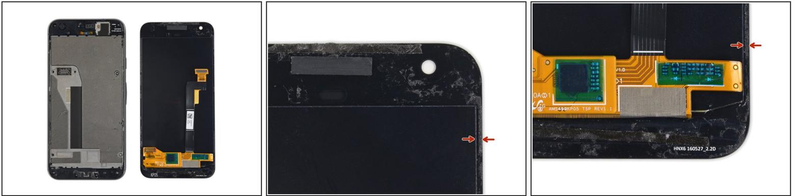
**i** En los siguientes pasos, separarás la pantalla cortando el adhesivo entre la pantalla y el chasis del Pixel
