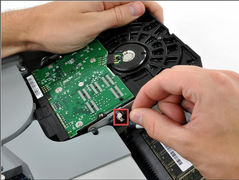
⚠ La siguiente acción es opcional. Si omites este paso, ten mucho cuidado de no tensar el cable del sensor térmico al desconectar los cables del disco duro y transferir este soporte al nuevo disco duro.
