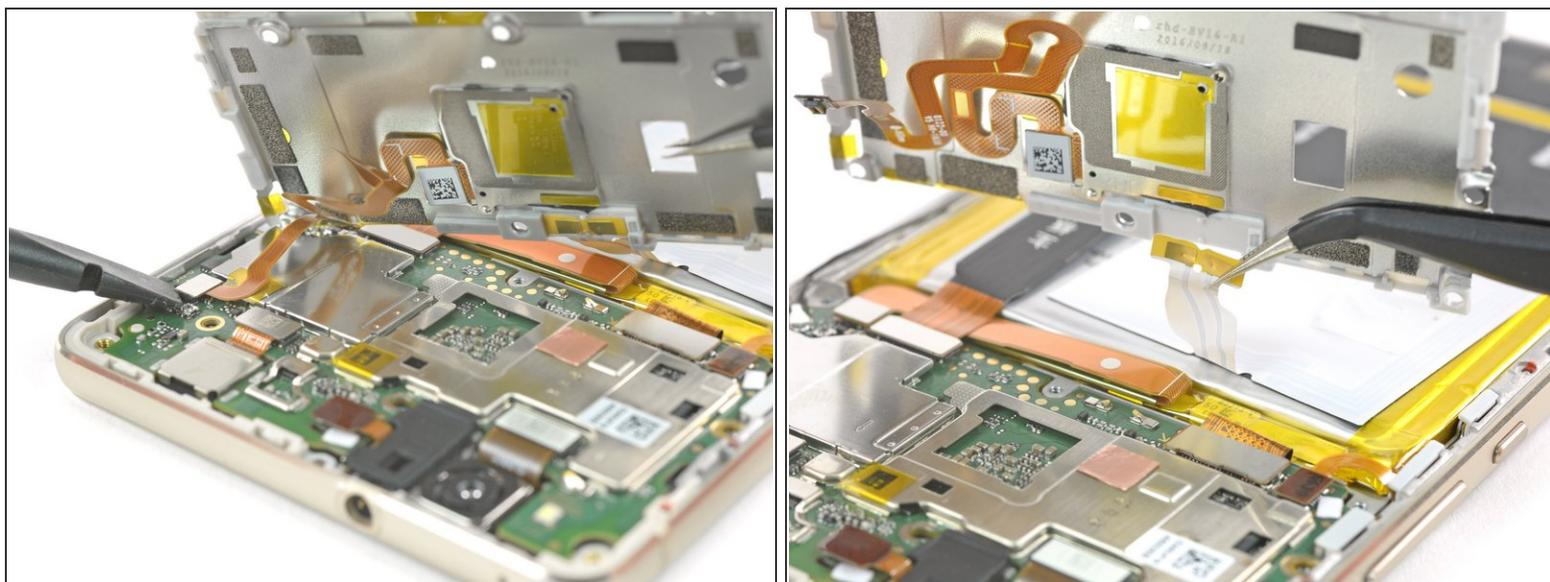
**⚠** No remuevas la placa de escudo aun ya que está sujeta por un conector y un cable adherido.
