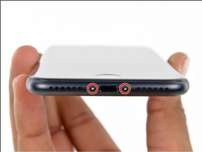
**⚠** Antes de comenzar, descarga la batería de tu iPhone por debajo del 25%. Una batería de iones de litio cargada puede incendiarse y / o explotar si se perfora accidentalmente.
