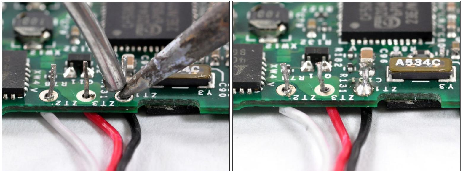
**i** En este paso, soldarás los cables de la batería a las almohadillas de soldadura en la placa lógica.
