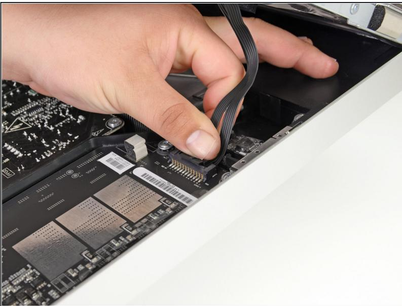
⚠ Este paso acerca tus manos a la parte posterior expuesta de la fuente de alimentación. Para evitar una descarga de alto voltaje de los muchos condensadores grandes conectados a la placa, **NO toques la parte posterior de la fuente de alimentación.**
