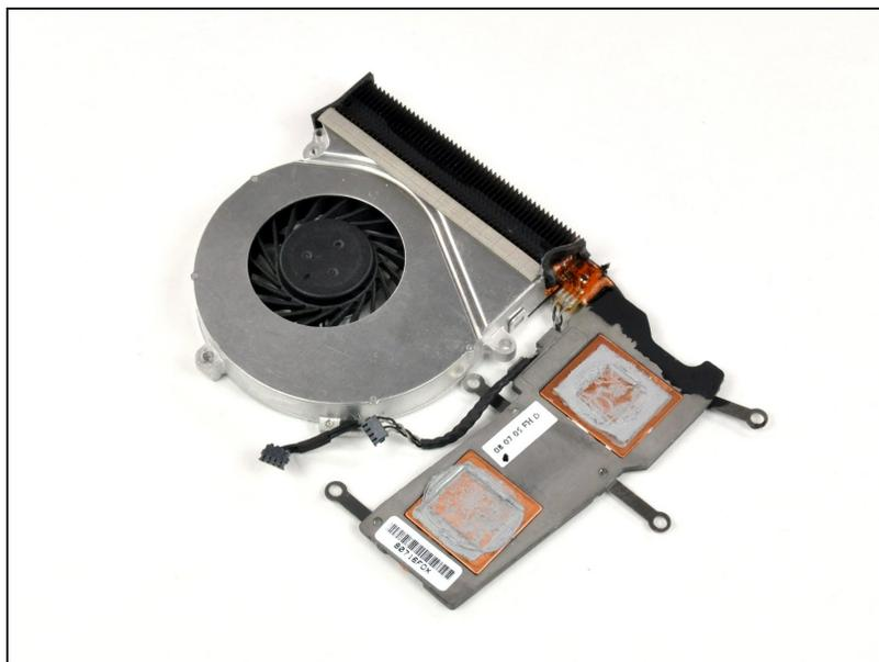
⚠️ La pasta térmica es responsable de conducir el calor desde el procesador hasta el disipador. Ensamblar una computadora sin aplicar pasta termal puede causar un recalentamiento en el procesador, provocando daños permanentes.
