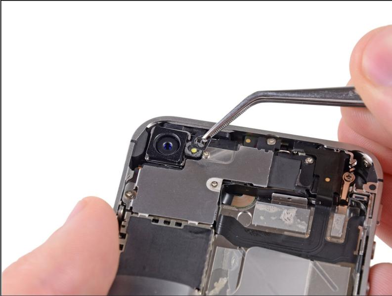
⚠ Ten cuidado con el anillo de plástico exterior ubicado en la parte superior del conjunto del flash de la cámara trasera. Puedes desplazarse fácilmente si no se retira durante el desmontaje.
