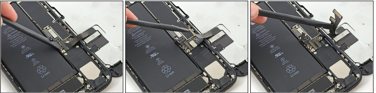
**⚠ Asegúrate de que la batería esté desconectada antes de desconectar o volver a conectar los cables en este paso.**
