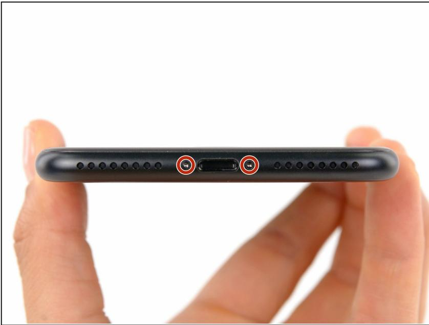
**⚠** Antes de comenzar, descarga la batería de tu iPhone por debajo del 25%. Una batería de litio cargada puede prenderse fuego y/o explotar si se la pincha accidentalmente.
