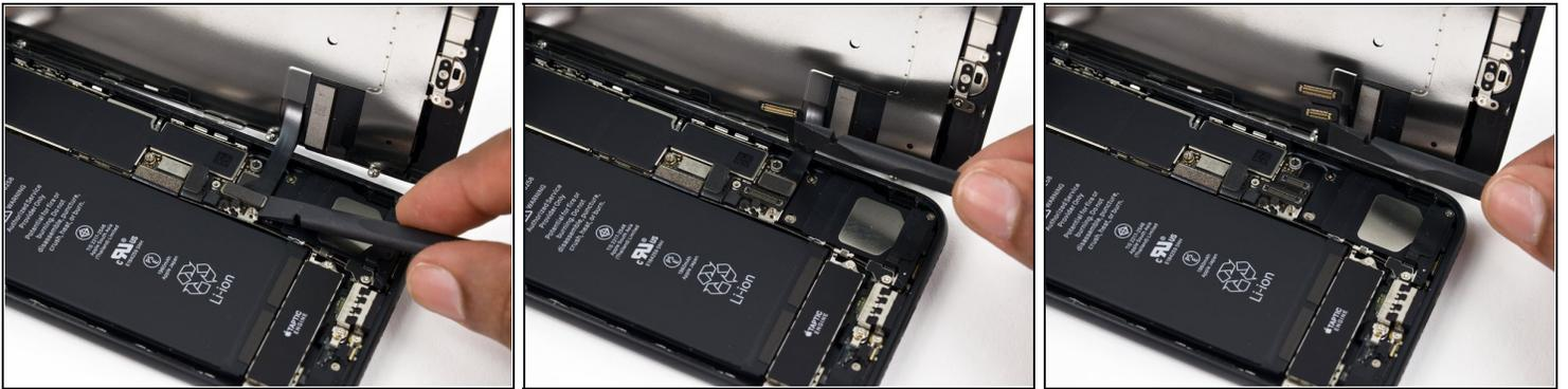
**⚠ Asegúrate de que la batería esté desconectada antes de desconectar o reconectar los cables en este paso.**
