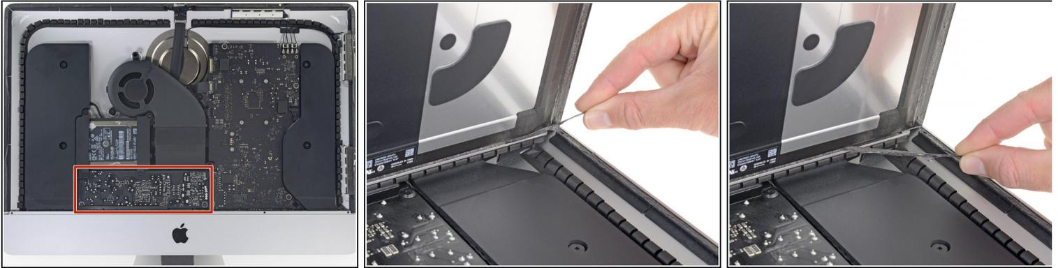
**⚠ Ten mucho cuidado de no tocar los cables del condensador o cualquier unión de soldadura expuesta en la parte posterior de la fuente de alimentación (encuadrada en rojo).**
