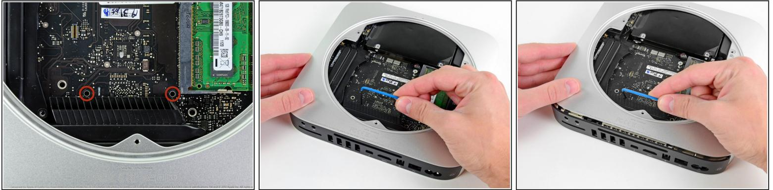
**⚠** Para extraer la placa lógica, las dos varillas cilíndricas de la herramienta de extracción de la placa lógica de Mac mini deben insertarse en los orificios resaltados en rojo. Insertar instrumentos en cualquier orificio de la placa lógica que no sean los resaltados en rojo puede destruir la placa lógica.
