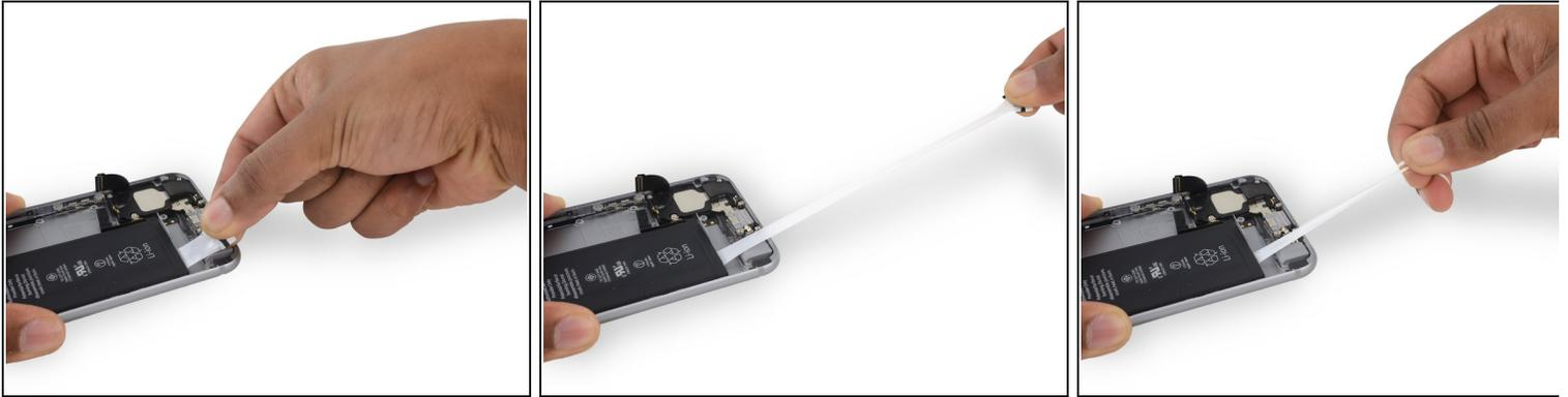
**⚠** 在撕的过程, 记得保持胶带平整, 不要让胶带起皱。起皱后的胶带会黏在一起, 或造成在拉扯中造成断裂。
