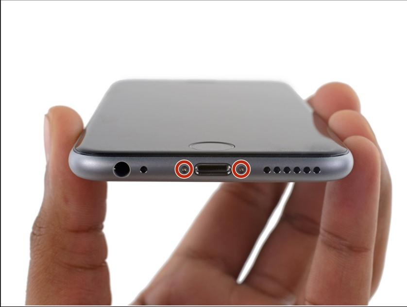
**⚠** 在拆卸iPhone之前，请将电池放电至25%以下。充电的锂离子电池如果意外被刺破可能会着火和/或爆炸。
