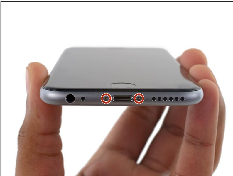
⚠ Antes de desarmar su iPhone, descarga la batería por debajo del 25%. Una batería de litio cargada puede generar fuego o explotar si es perforada accidentalmente.
