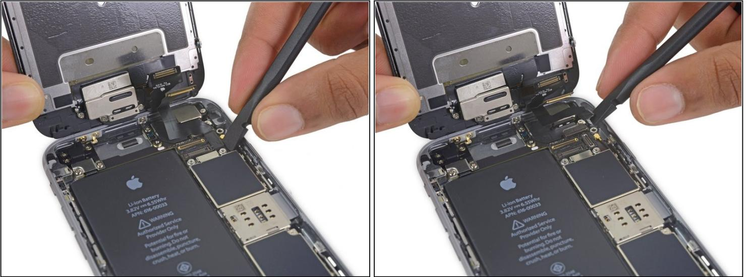
**⚠ Asegúrate de que la batería esté desconectada antes de desconectar o reconectar el cable es este paso.**
