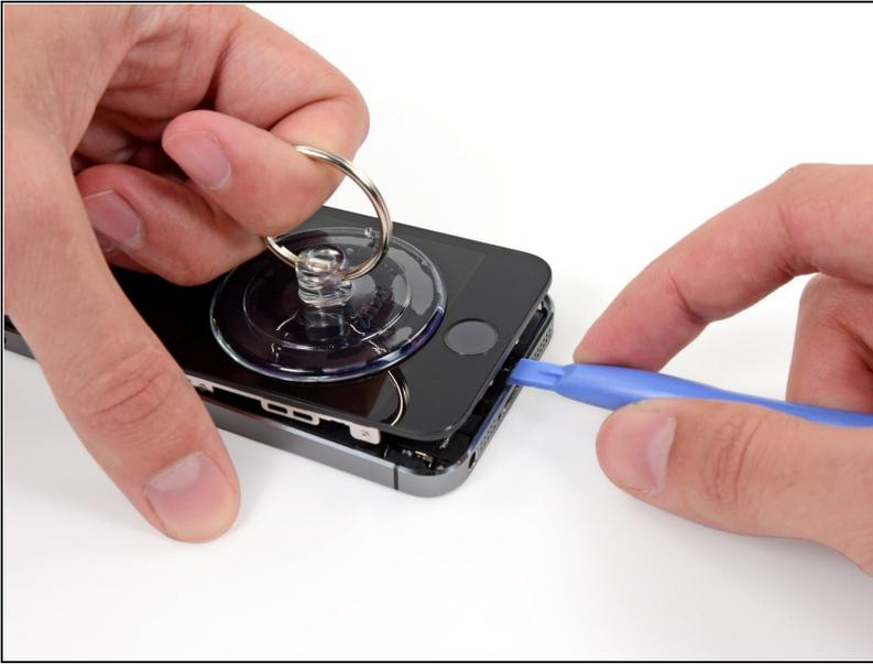
⚠ El panel frontal tiene una serie de clips en los laterales, y hay varios cables que conectan la pantalla al resto del teléfono. Tu misión aquí es separar los clips y **abrir el teléfono solo lo suficiente como para desconectar los cables**. Vete despacio y con cuidado para evitar daños.
