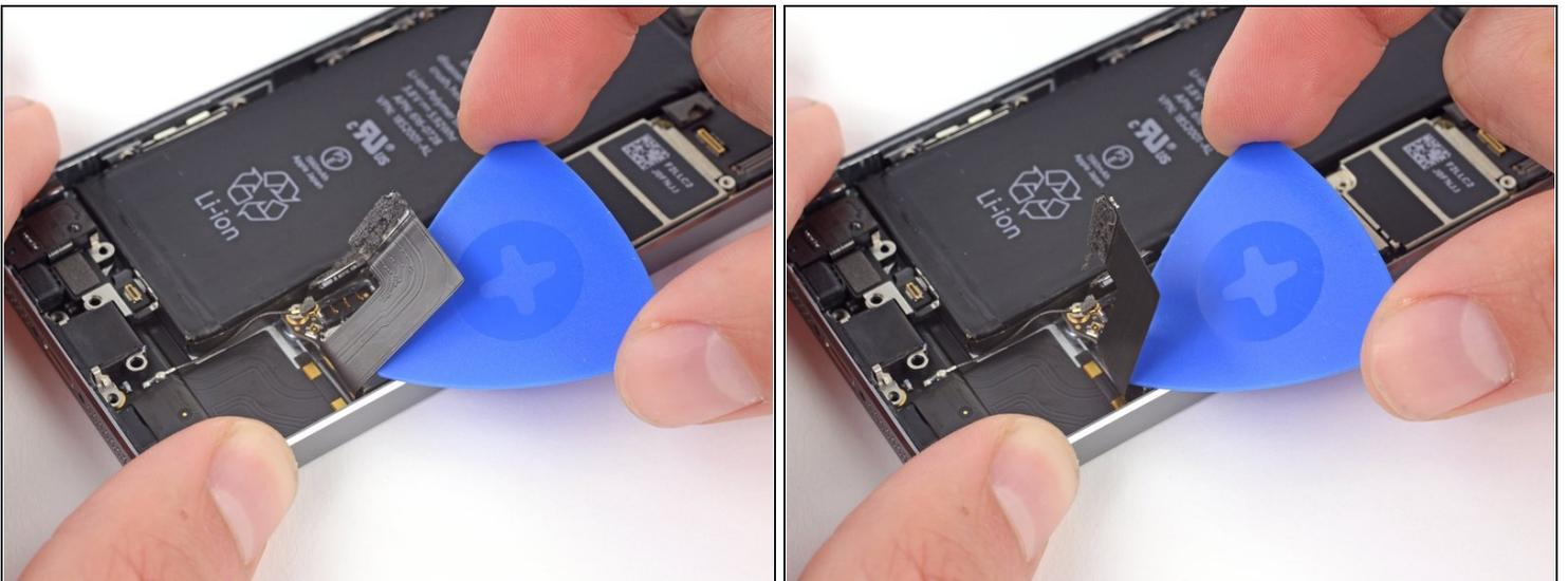
ⓘ El cable de datos del conector Lightning se mantiene a la placa lógica y la carcasa trasera con pegamento moderado.
