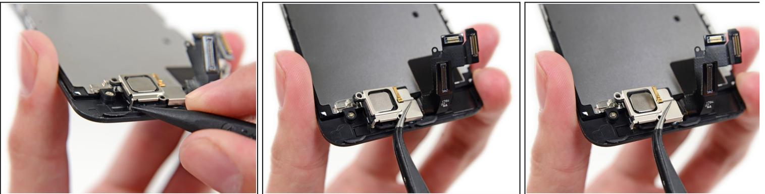
**i** Orienta el teléfono como se muestra, con el botón de inicio en la parte superior y el altavoz del auricular en la parte inferior.
