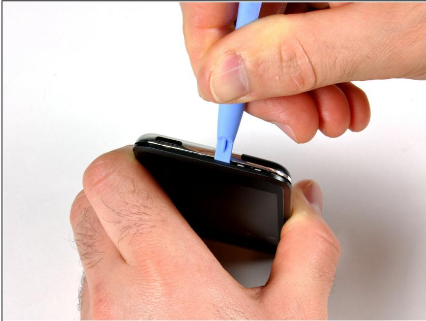
**⚠** Abrir la carcasa es una tarea difícil y potencialmente peligrosa. Se requiere una buena cantidad de fuerza para encajar la herramienta de apertura de plástico entre las costuras de la carcasa. La carcasa puede dañarse si este paso no se realiza correctamente. Asegúrate de no lastimarte mientras abres tu iPod.
