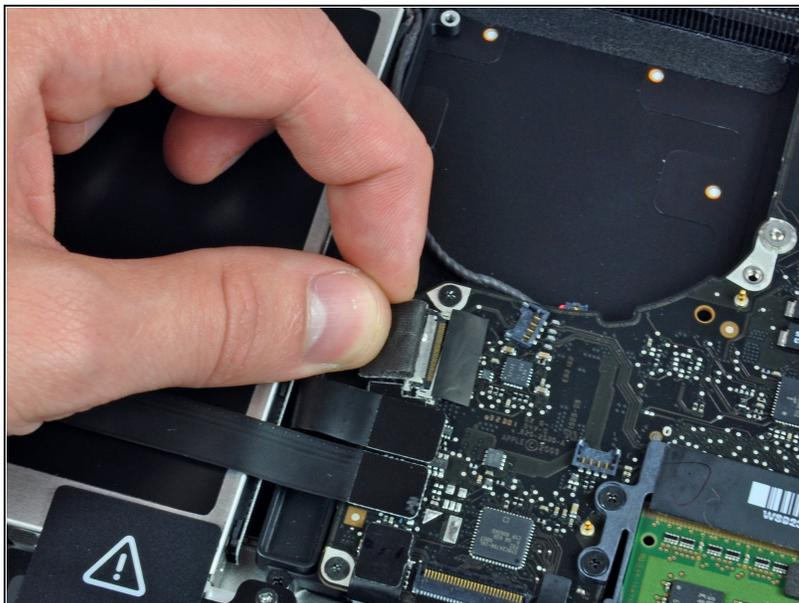
⚠ En este paso desconectará el cable de la cámara. La mayoría de las máquinas tendrán un pequeño retenedor de plástico autoadhesivo pegado a la placa lógica para mantener el conector en su lugar. Antes de desconectar el cable, asegúrese de que este retenedor esté fuera del camino.
