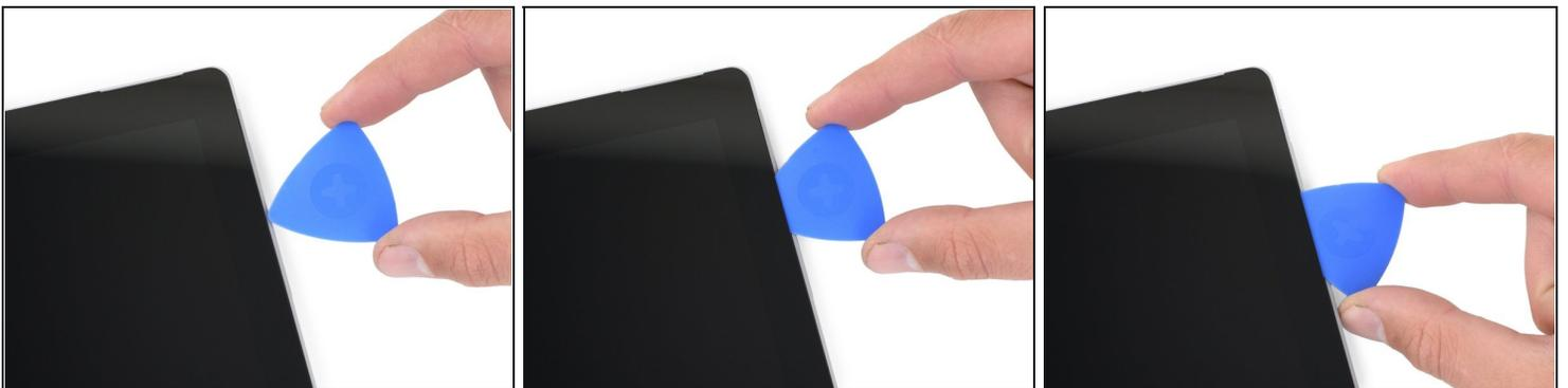
**⚠** Los frágiles cables de la antena se encuentran bajo el borde superior de la pantalla. Sigue el procedimiento con cuidado para no dañarlos.
