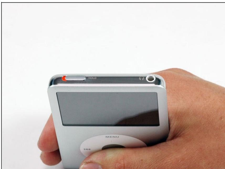
ⓘ Apple diseñó sus nuevos iPods para ser muy difíciles de desarmar sin destruir componentes importantes. Debido a la placa frontal metálica, soporte metálico y los 13 (sí, 13) clips metálicos sosteniendo al armazón, este es uno de los iPods más difíciles de desarmar.
