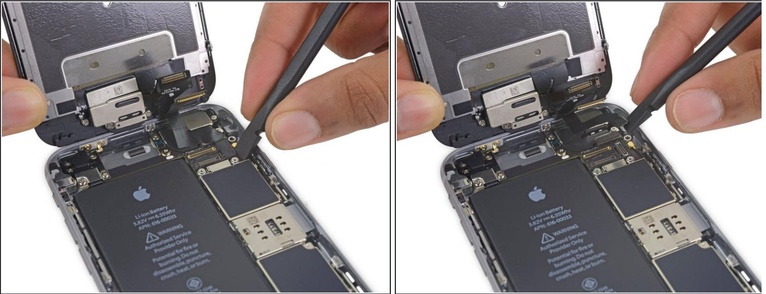
**⚠ Asegúrate de que la batería esté desconectada antes de desconectar o reconectar el cable es este paso.**
