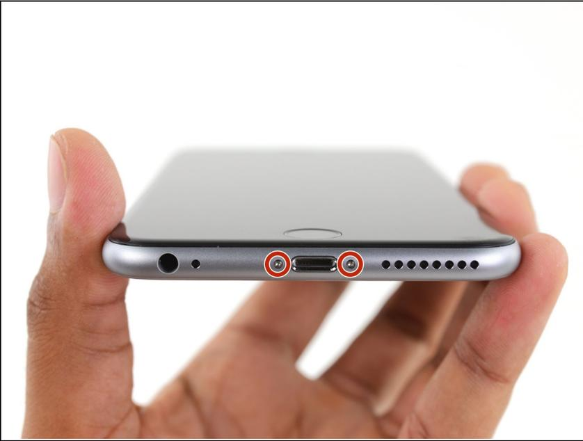
**⚠** Antes de desarmar su iPhone, descarga la batería por debajo del 25%. Una batería de litio-ion cargada puede incendiarse y / o explotar si se pincha accidentalmente.
