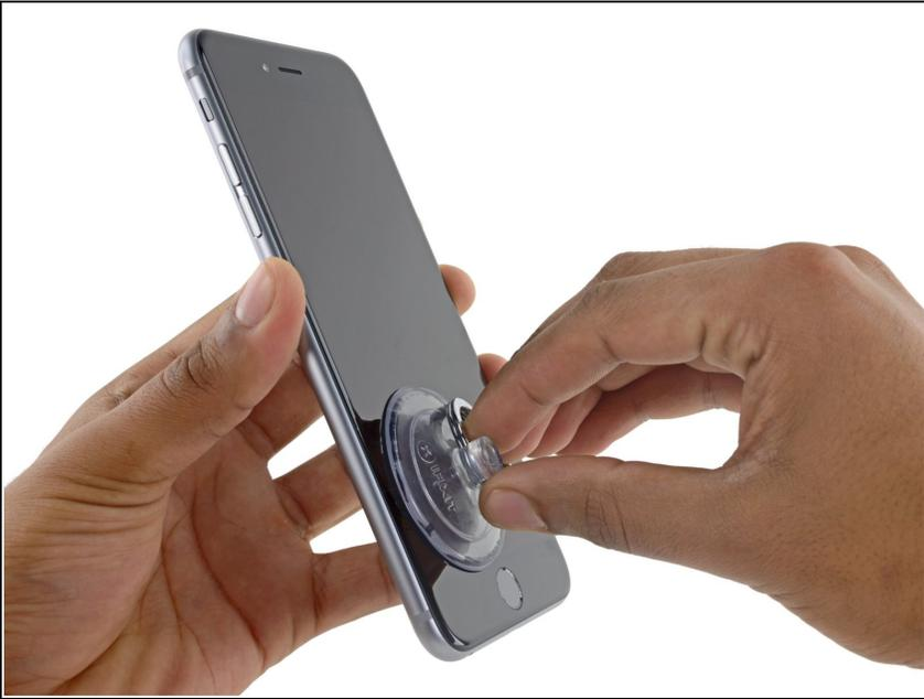
**i** Al abrir la pantalla en el 6s Plus, se separa una delgada tira de adhesivo alrededor del perímetro de la pantalla. Si prefieres reemplazar el adhesivo, ten listo un conjunto de nuevas tiras adhesivas antes de continuar. Es posible completar la reparación sin reemplazar el adhesivo, y probablemente no notarás ninguna diferencia en la funcionalidad.
