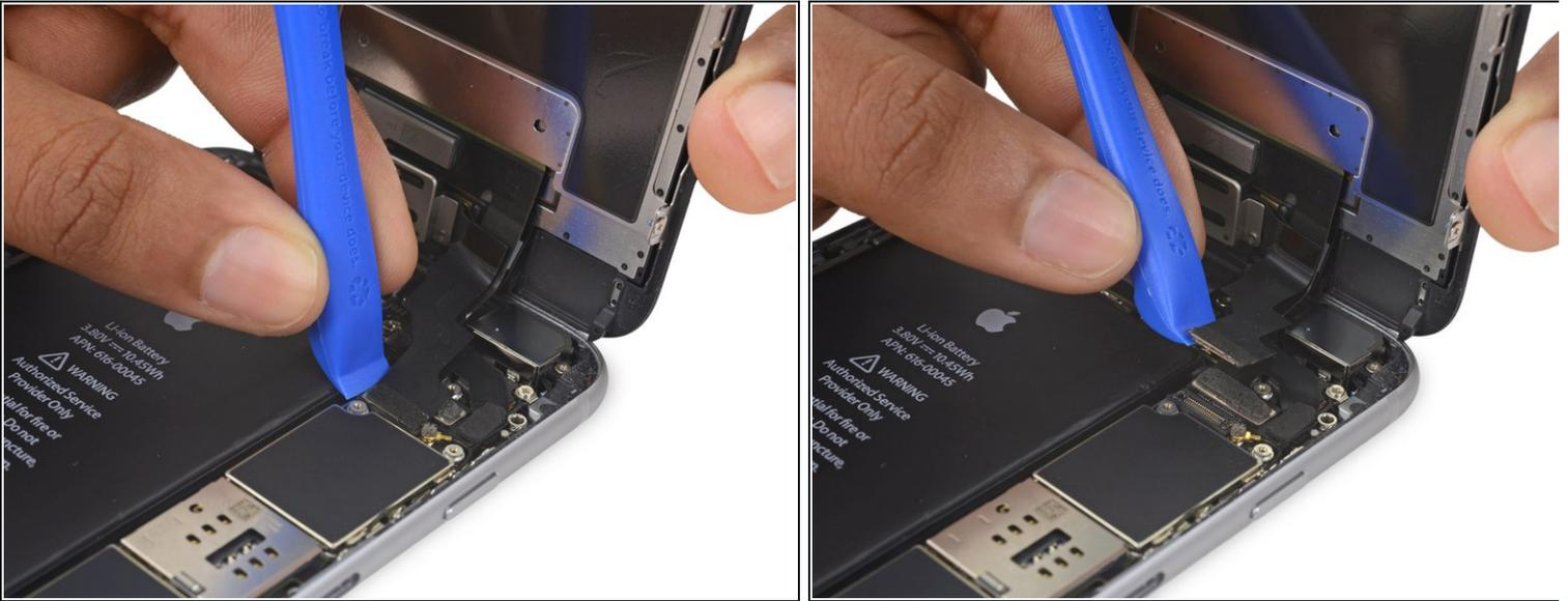
**⚠ Ten cuidado de solo levantar el conector y no el zócalo de la placa lógica.**
