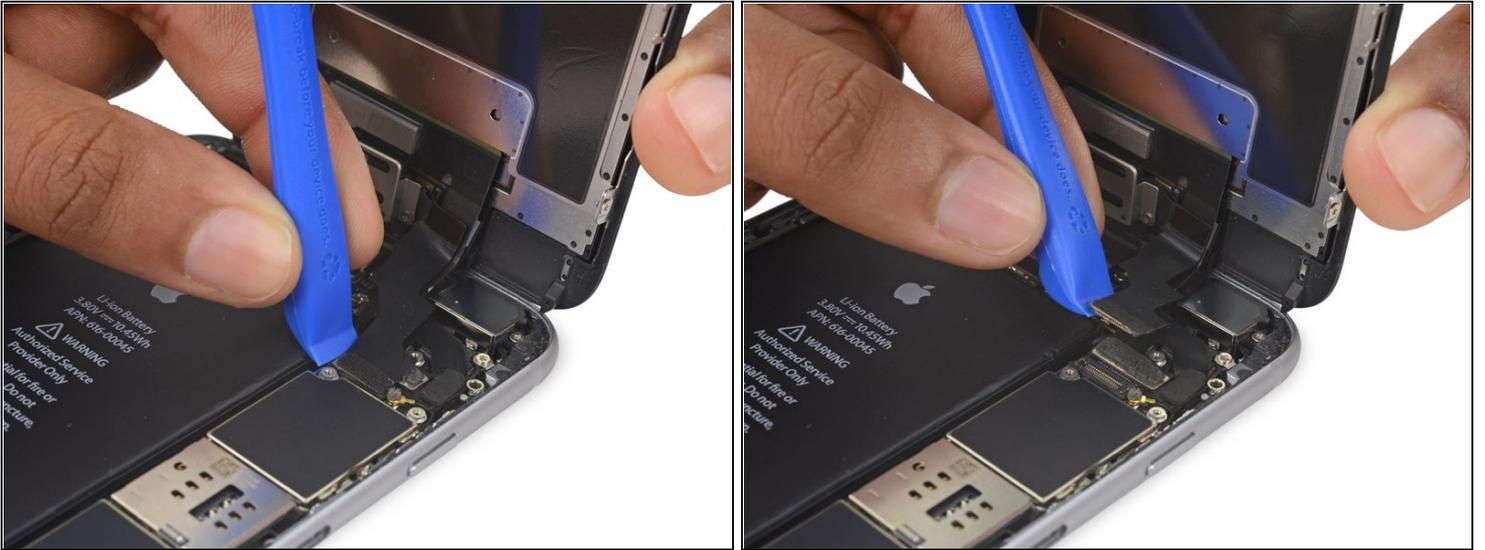
**⚠ Ten cuidado de solo levantar el conector y no el zócalo de la placa lógica.**
