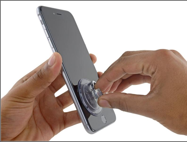
ⓘ Al abrir la pantalla en el 6s Plus, se separa una delgada tira de adhesivo alrededor del perímetro de la pantalla. Si prefieres reemplazar el adhesivo, ten listo un conjunto de nuevas tiras adhesivas antes de continuar. Es posible completar la reparación sin reemplazar el adhesivo, y probablemente no notarás ninguna diferencia en la funcionalidad.
