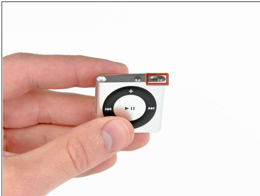
**⚠** Acceder a las partes internas de la 4ª generación de Shuffle es extremadamente difícil, ya que el panel posterior está pegado a la caja frontal y está asegurado con clips de retención metálicos. Es muy poco probable que puedas quitar el panel posterior sin causar daños estéticos y / o estructurales.
