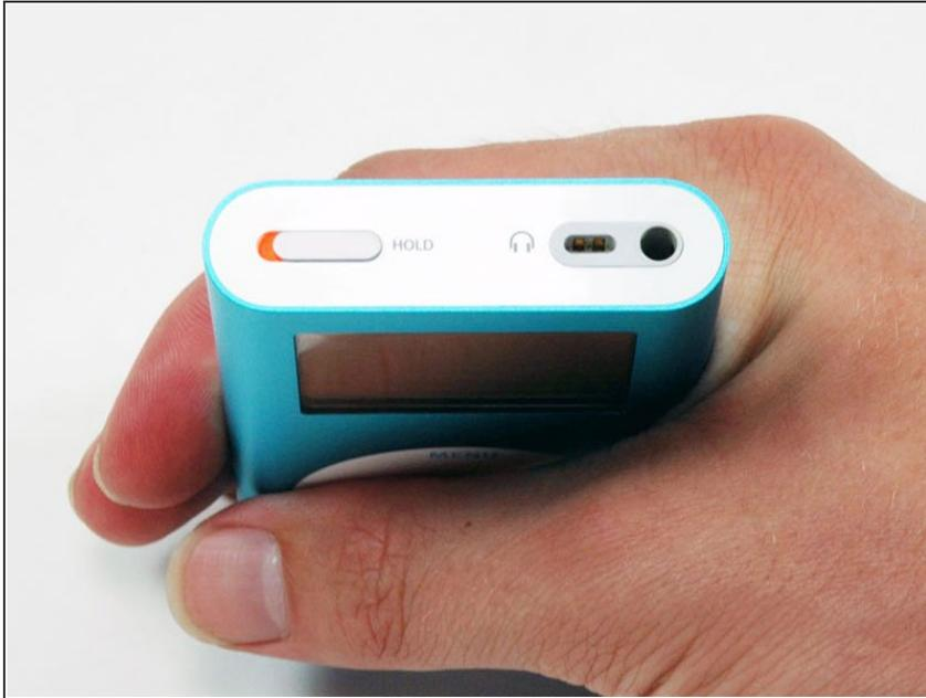
**i** Antes de abrir tu iPod, asegúrate de que el interruptor de espera esté en la posición de bloqueo.
