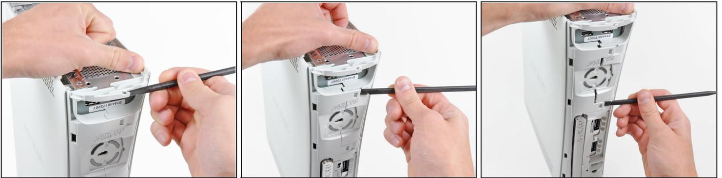
ⓘ Las carcasas superior e inferior se sujetan con varios pestillos, localizadas en la parte delantera y trasera de la consola. Estos pestillos deben ser desenganchados para separar la carcasa superior de la consola.
