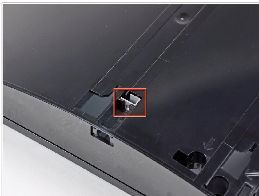
**⚠** Asegúrate de no perder de vista el raíl metálico en caso de que esté equipado en la carcasa superior.
