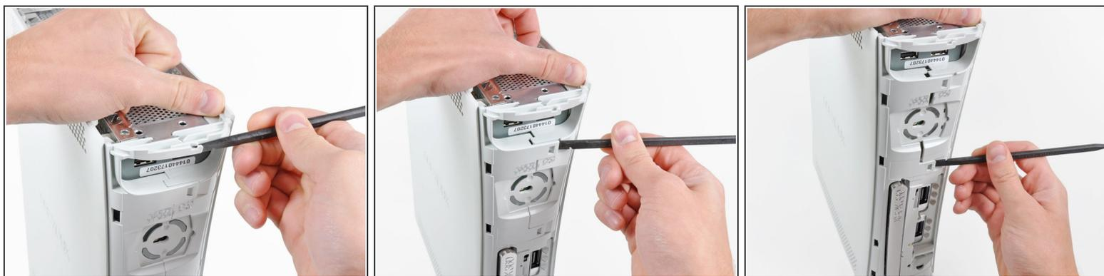
**i** Las carcasas superior e inferior se sujetan con varios pestillos, localizadas en la parte delantera y trasera de la consola. Estos pestillos deben ser desenganchados para separar la carcasa superior de la consola.
