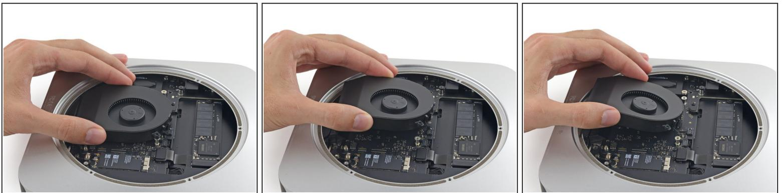
**i** El conector del ventilador está atrapado debajo del borde del ventilador y no se puede desconectar hasta que se mueva el ventilador.
