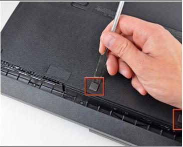
Utiliza la parte plana de un "spudger" para hacer palanca en los siete puntos que se encuentran en el borde de la carcasa inferior y que esconden bajo ellos tornillos. Puedes observar en la imagen dónde están localizados.
