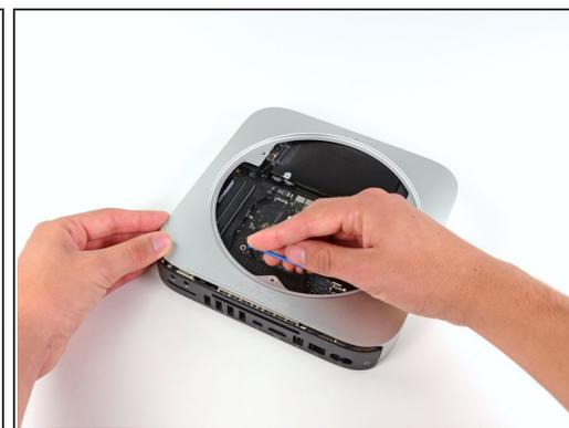
**i** Para tener suficiente espacio para remover el disco duro, la tarjeta lógica debe estar ligeramente fuera de su lugar. Para conseguir esto dos varillas cilíndricas deben ser insertadas en los agujeros remarcados en rojo.
