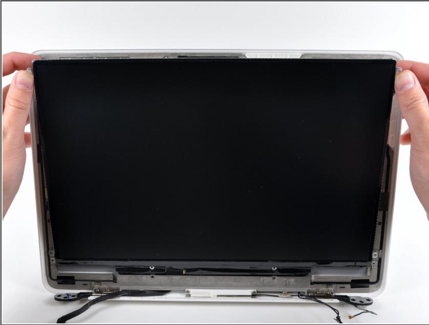
**⚠** No trates de remover el LCD aun. Los circuitos alrededor de su borde inferior están encajados en una ranura alrededor del borde inferior del hueco en el ensamble de plástico de la pantalla.
