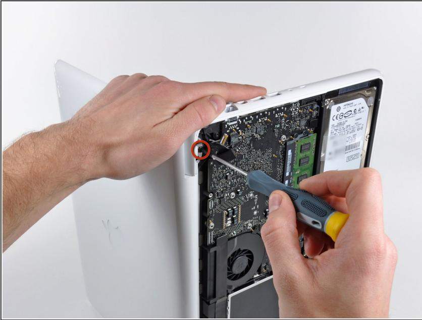
**⚠** Procura sujetar la pantalla y la carcasa superior con la mano izquierda. De lo contrario, la pantalla y la carcasa superior liberadas pueden caer, dañando potencialmente cada componente.
