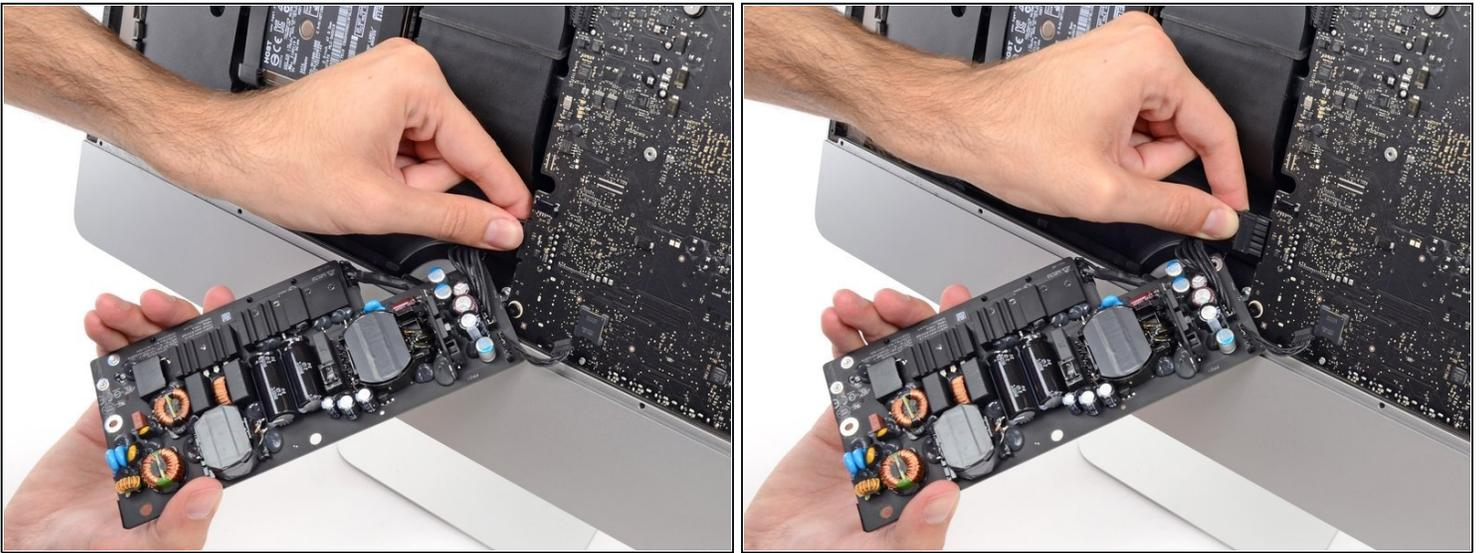
**⚠** Ten mucho cuidado de no tocar los cables del condensador o cualquier junta de soldadura expuesta en la parte posterior de la fuente de alimentación. Solo maneja el tablero por los bordes.
