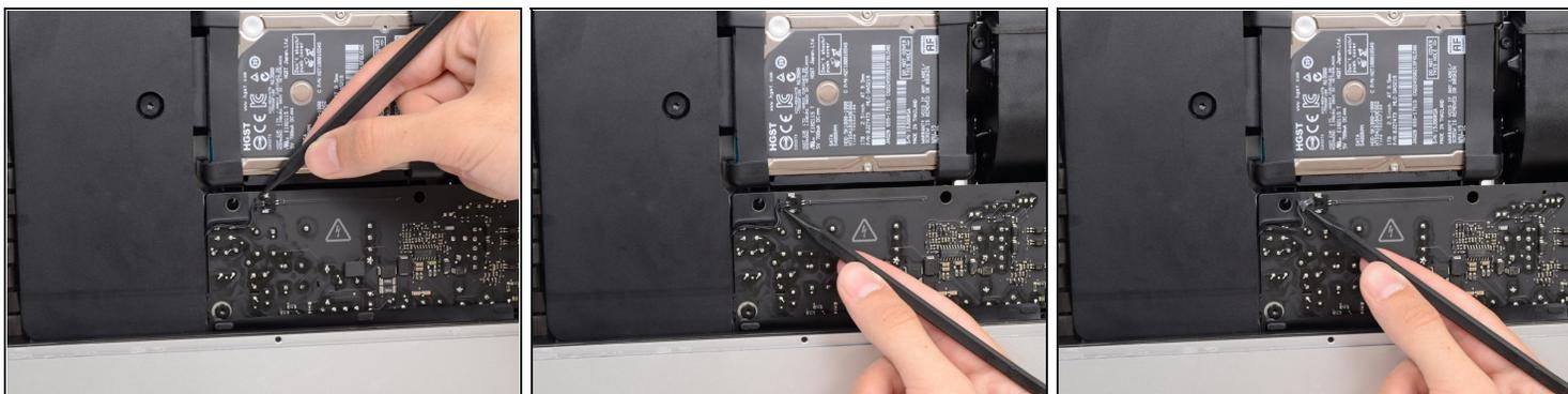
**⚠** Los siguientes pasos acercan sus manos a la cara expuesta de la fuente de alimentación. No toques la cara de la fuente de alimentación ni ninguna de las soldaduras expuestas. Al tocarlo se corre el riesgo de una descarga de alto voltaje de los muchos condensadores grandes conectados a la placa.
