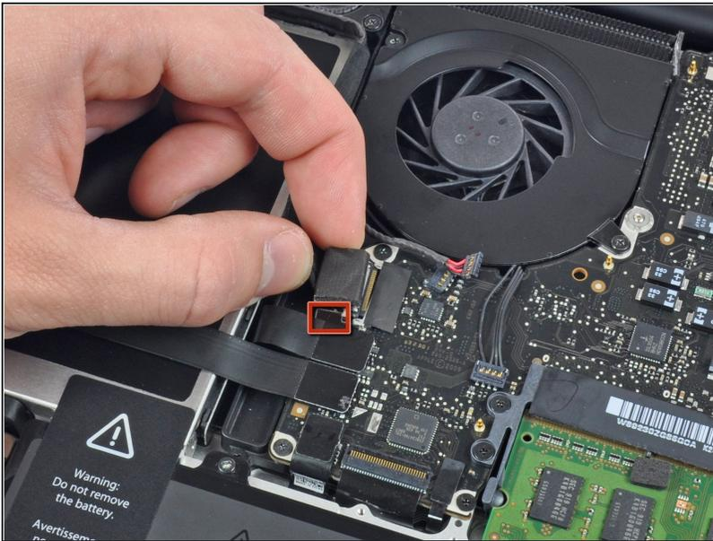
⚠ Será necesario deslizar el pequeño retenedor de cable de plástico transparente (recuadro en rojo) pegado a la placa lógica antes de desconectar el cable de la cámara. Ten cuidado de no romper ningún componente de la placa al deslizarla para separarla del conector del cable de la cámara.
