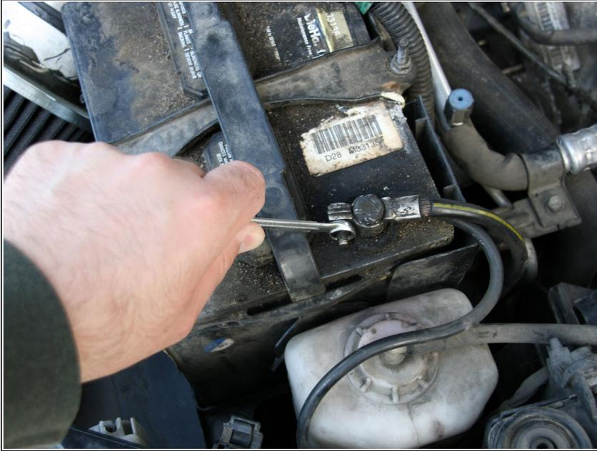
**⚠** Antes de continuar: desconecta la batería. Guardo una llave de 10 mm en mi consola central específicamente para este propósito.
