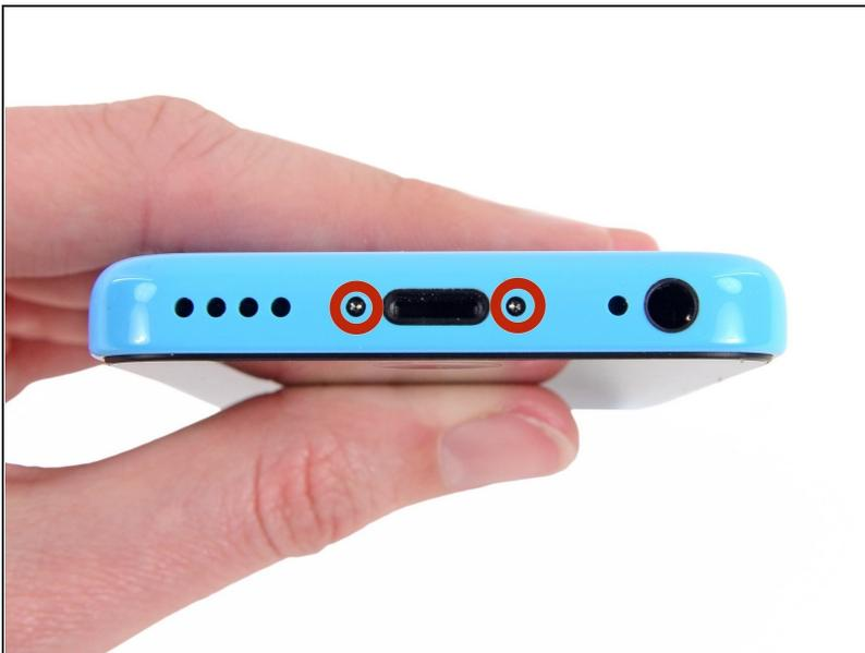
**⚠ Antes de continuar, descarga la batería de tu iPhone por debajo del 25%. Una batería de ion de litio puede arder y/o explotar si se perfora accidentalmente.**
