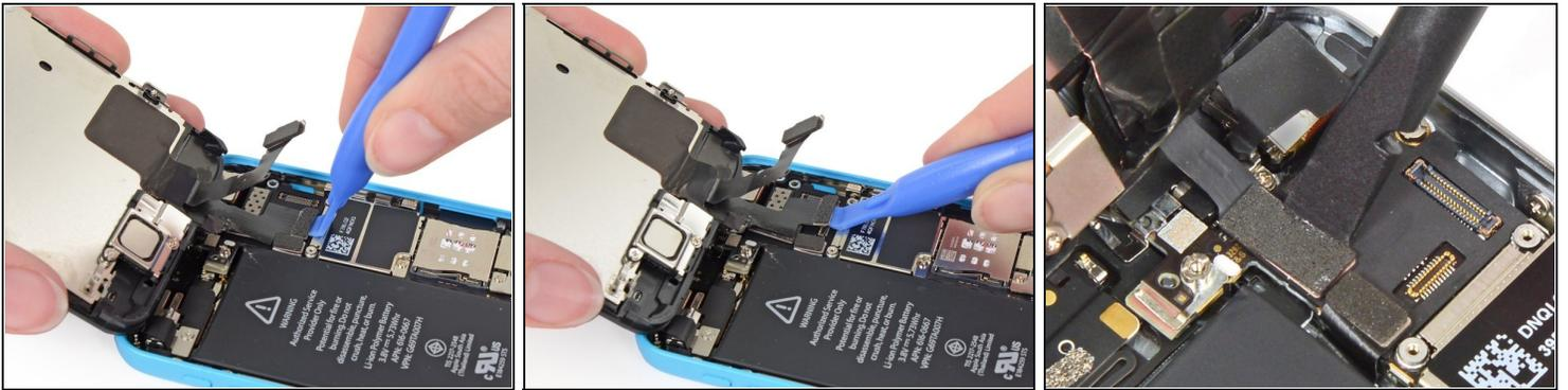
**⚠ Asegúrate de que la batería está desconectada antes de desconectar o reconectar los cables en este paso.**
