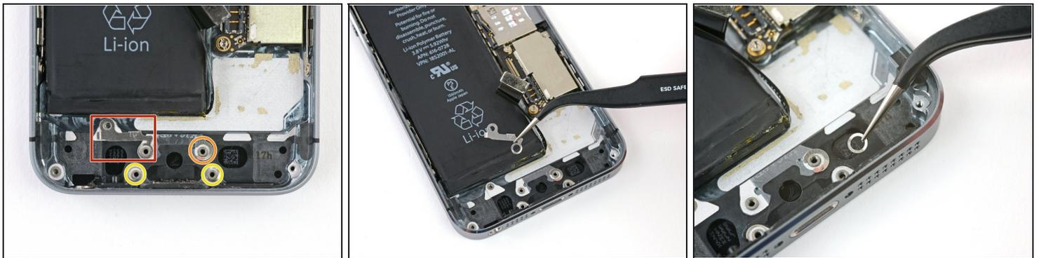
ⓘ Hay varios espaciadores flojamente colocados en los postes de los tornillos debajo del módulo del conector Lightning. Aunque no son necesarios para el funcionamiento, deberías reemplazar esas arandelas cuando vuelvas a armar el teléfono. Los espaciadores quizás varían entre dispositivos, esta unidad tiene espaciadores como se indica:
