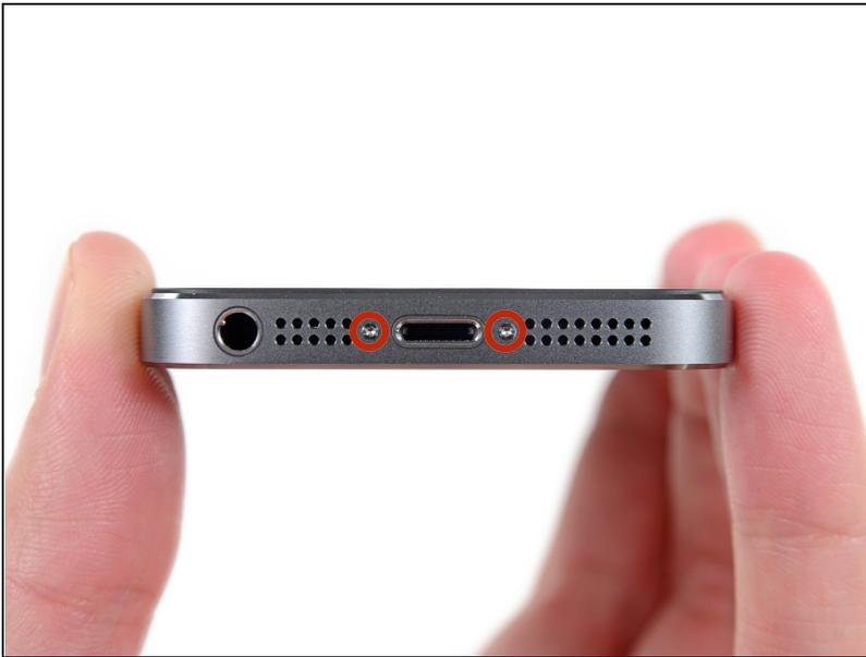
**⚠** Antes de continuar, descarga la batería del iPhone por debajo del 25%. Una batería de litio-ion cargada puede incendiar y / o explotar si se presiona accidentalmente.
