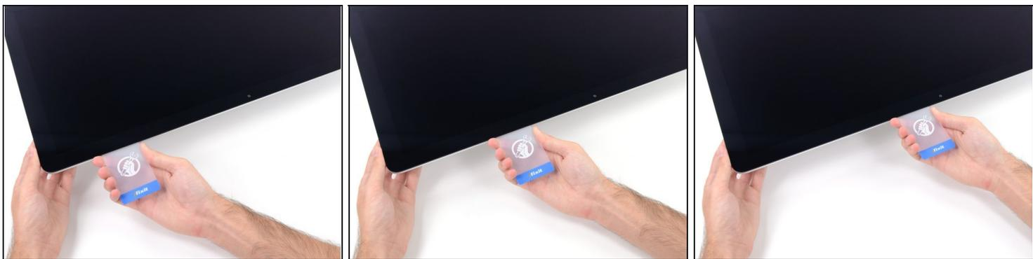
**⚠ Asegúrese de detener el corte antes de la cámara iSight en este paso, o puede dañarlo.**
