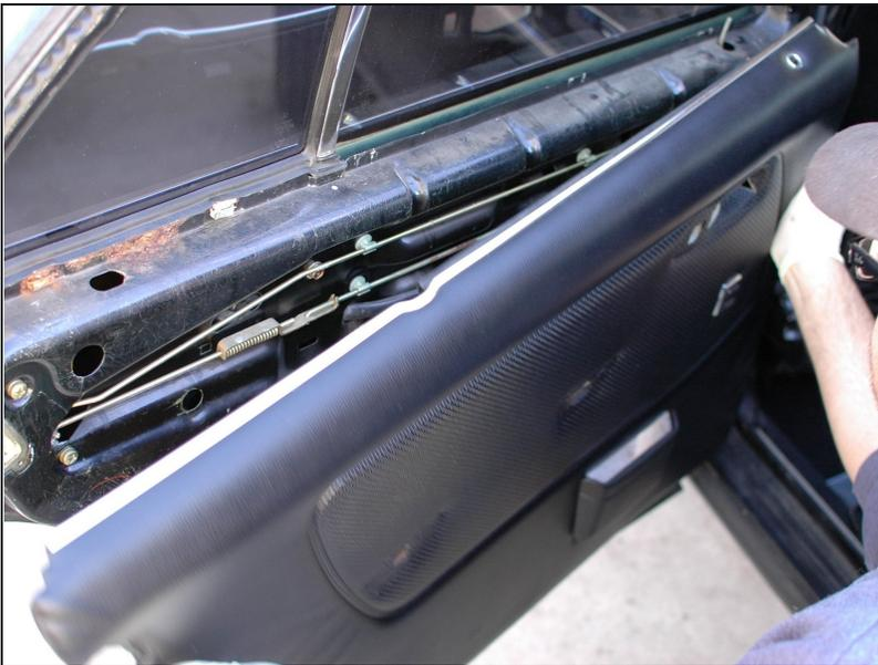
⚠ Retira el panel tirando de él hacia arriba. No tires directamente del panel, ya que podría doblarse. Esto no se puede reparar. Si tiras del panel hacia arriba antes de extraerlo, también te asegurarás de no dañar los clips de plástico de la parte trasera del compartimento para mapas del panel de la puerta-
